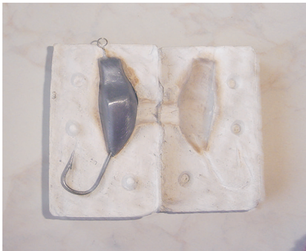
Εικόνα 26: Η ζόκα αυτή και το καλούπι της είναι δικής μου ... παραγωγής. Η διαφορά της από αυτήν του εμπορίου, είναι ότι αντί για τρύπα έχει δακτύλιο από ανοξείδωτο σύρμα, για να μπορεί να δένεται και με στριφταροπαραμάνια.
